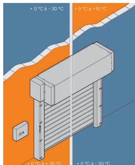
Les chauffages intégrés des surfaces de contact permettent des températures d'utilisation entre plus 30 °C et moins 30 °C.
