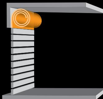
La spirale ronde est l'équipement standard, et c'est la solution idéale lorsque la place au-dessus de la porte est suffisante.
